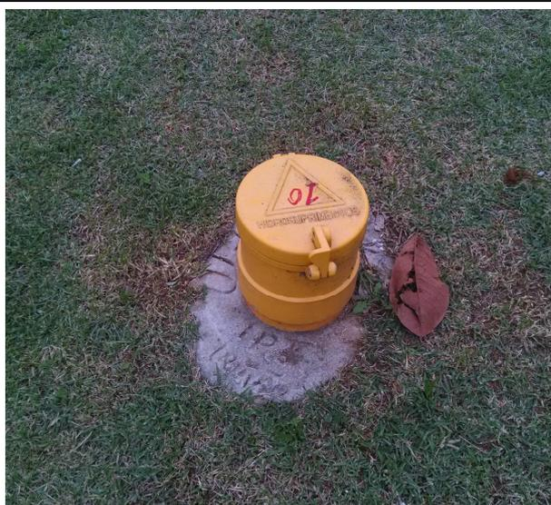
**Foto 01:** Poço de monitoramento de água – tampa sem cadeado e com marcação à caneta.
